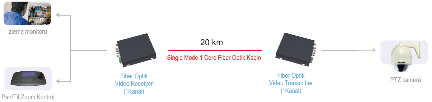
Fiber optik sistem konfigürasyonu (1 Analog Kamera)
